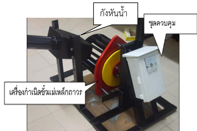
ภาพที่ 4 เครื่องกำเนิดไฟฟ้าพลังงานน้ำขนาดเล็ก
