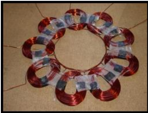
ภาพที่ 1 ขดลวดสเตเตอร์จำนวน 9 ขดต่อแบบสตาร์
