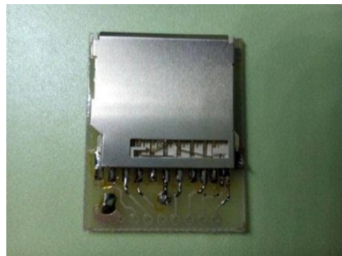
ภาพที่ 4 ออกแบบและบัดกรี SD Card ตามที่กำหนด
