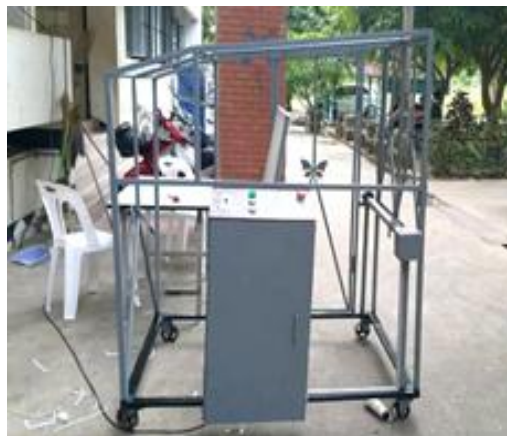
ภาพที่ 2 ตู้ควบคุมเครื่องฝ้ายมัดหมี่ระบบอัตโนมัติ (ด้านข้าง)
